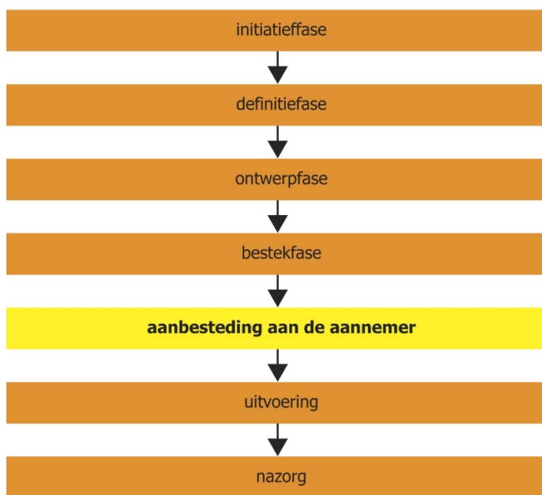
figuur 5-1 stroomschema aanpak bouw zwem- en sportcentrum
